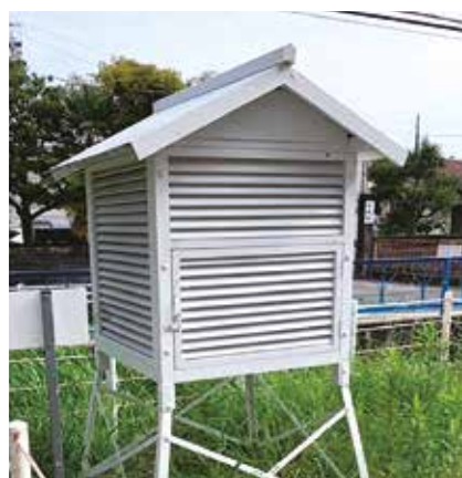
5. L'altezza della stazione di misurazione delle temperature (questa piccola stazione si trova all'interno di una scuola elementare) varia tra i 120 e i 150 cm. A questo livello, la stazione non viene colpita dalla calura del terreno sottostante.
